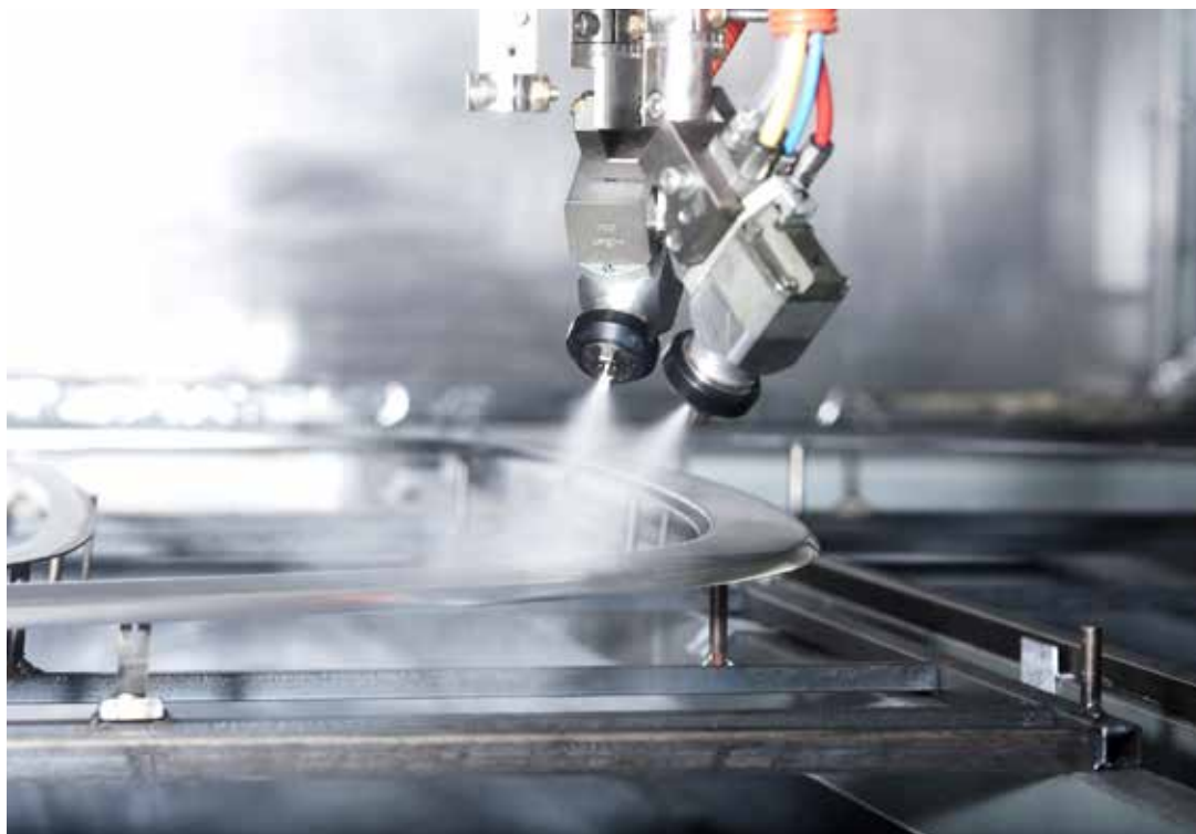
Einsatz des ALUCERAM-Verfahrens zum Schutz der Aluminiumoberfläche
